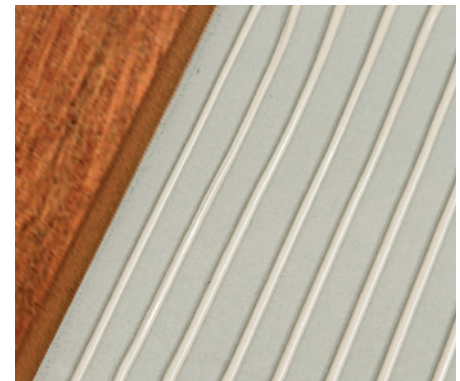
Durch das mechanische Auftragen des Klebstoffes entsteht ein gleichmäßiges Kleberbild.
