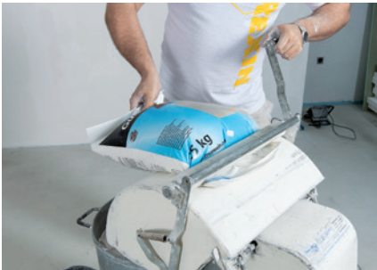
Einlegen des Kunststoffesackes (mit der Bodenlasche) in die Sackpresse
