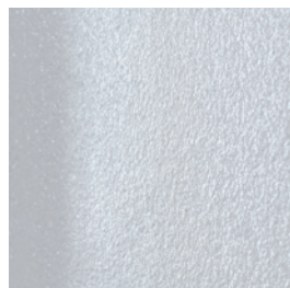
Gleichmäßige und raue Oberfläche: Abziehen und Schleifen ist nicht notwendig.
