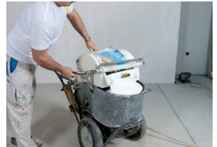
Entleerung des Kunststoffesackes mittels Handkurbel
